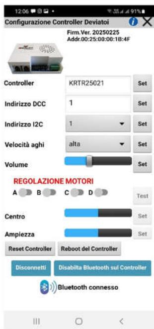
Quando la connessione è attiva il led del controller lampeggia in maniera asincrona (lampeggio corto), il Tab restituisce tutti i valori di default memorizzati dal Controller, nell'esempio il Tab di un Controller per Passaggio a Livello e per Deviatoi.
