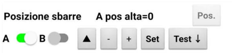
Cliccando sulla freccia si selezionerà il punto di arresto da modificare (posizione alta o posizione bassa della sbarra selezionata). Il valore verrà ricavato da quello memorizzato nel controller e la sbarra si muoverà di conseguenza.
